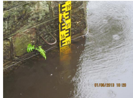
Abbildung 7-7: Beckenpegel am Spitzgrundteich mit Pegellatte am Auslaufbauwerk
